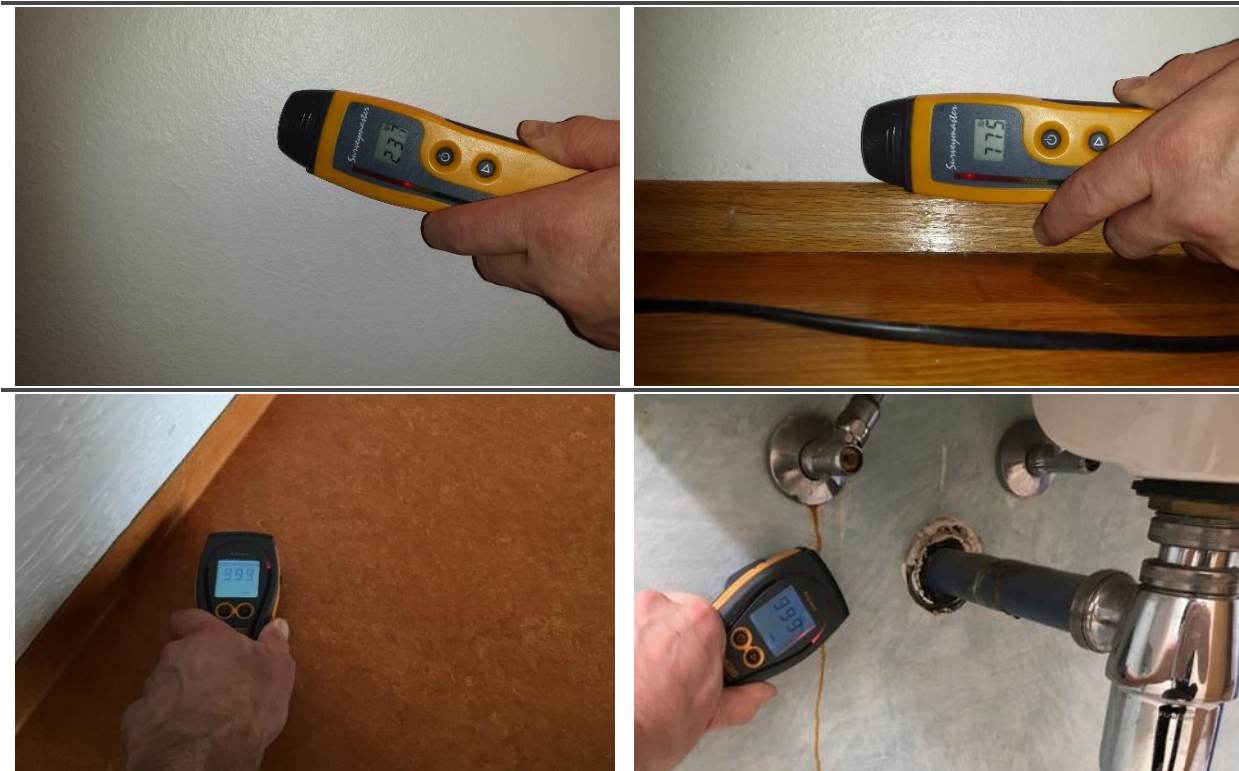
MYND B. Dæmi um viðmiðunarmælingu og frávikaskráningu; merkt er inn á teikningu hækkaður raki á vegg neðst við gólf. Merkt er inn á teikningu hækkaður raki í gólfi við útvegg. Merkt inn á teikningu hækkaður raki í vegg neðan við vask.
