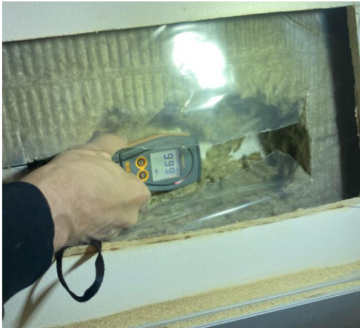
Mynd 5. Hækkaður raki í steiptum útvegg í stofu 111
