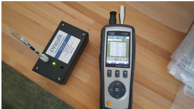
MYND H Sýnataka á VOC efnum og agnatáling
