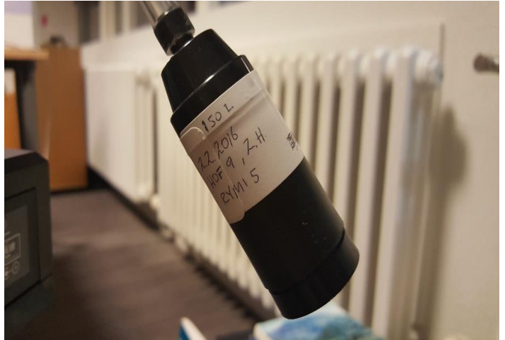
MYND 1 Sýnataka asbest þráðum og agnatalning
